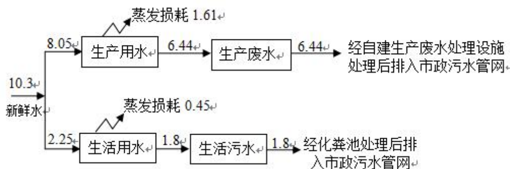
图 2-1 实际运行的水量平衡图（t/d）
